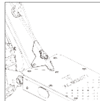
A) Portul de încărcare cu capac se află în partea din față a platformei.
