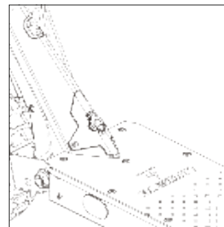
A) Nabíjecí port s krytkou je v přední části nášlapné plochy.
