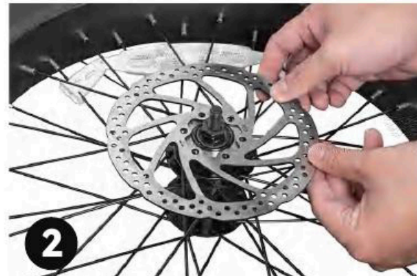
Krok 2: Zarovnajte 6 otvorov kotúča so 6 príslušnými otvormi na náboji.
