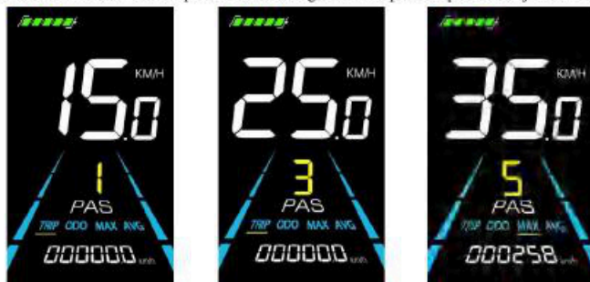
Figure 5-3 PAS level display interface
