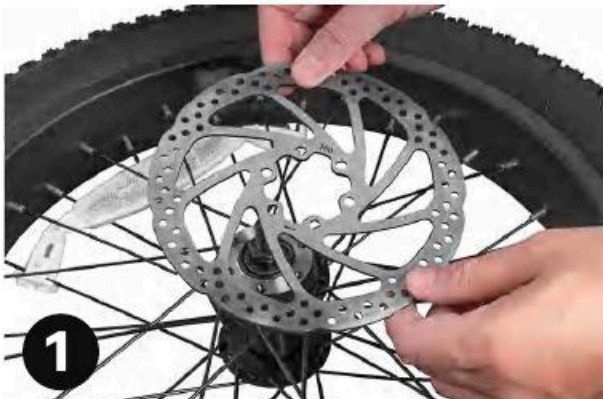
Krok 1: Nasadíte brzdový kotúč na náboj predného kola.
