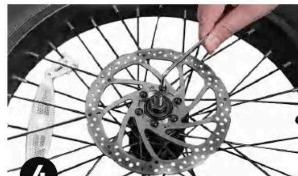
Krok 4: Dotáhněte with a 4mm imbusový klíč.
