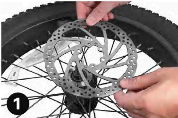
Lépés 1: Place the brake rotor on the első kerék hub.
