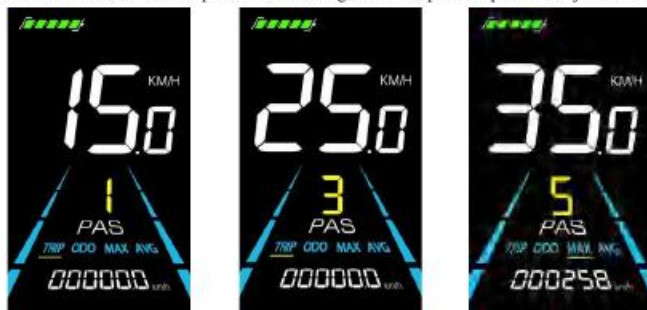
Figure 5-3 PAS level display interface
