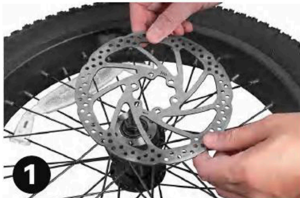
Krok 1: Place the brake rotor on the přední kolo hub.
