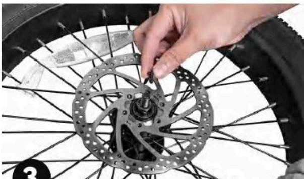
Lépés 3: Helyezze be the 6 brake screws.
