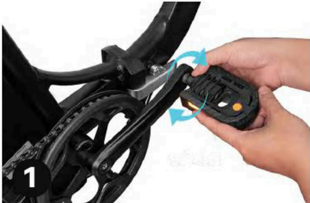
Pasul 1: Install the right pedal marked “R” în sens orar by hand, then tighten it în sens orar with a 15mm cheie.
