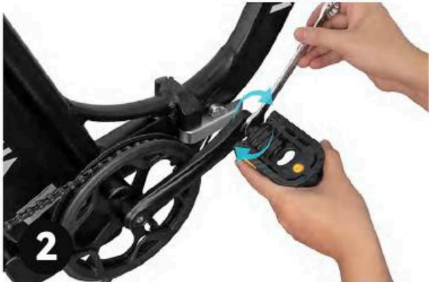
Pasul 2: Install the left pedal marked “L” în sens antiorar by hand, then tighten it în sens antiorar with a cheie.
