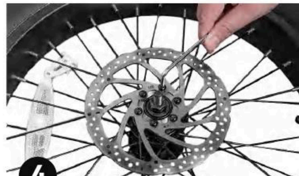
Krok 4: Skrutky dotiahnite 4mm imbusovým kľúčom.
