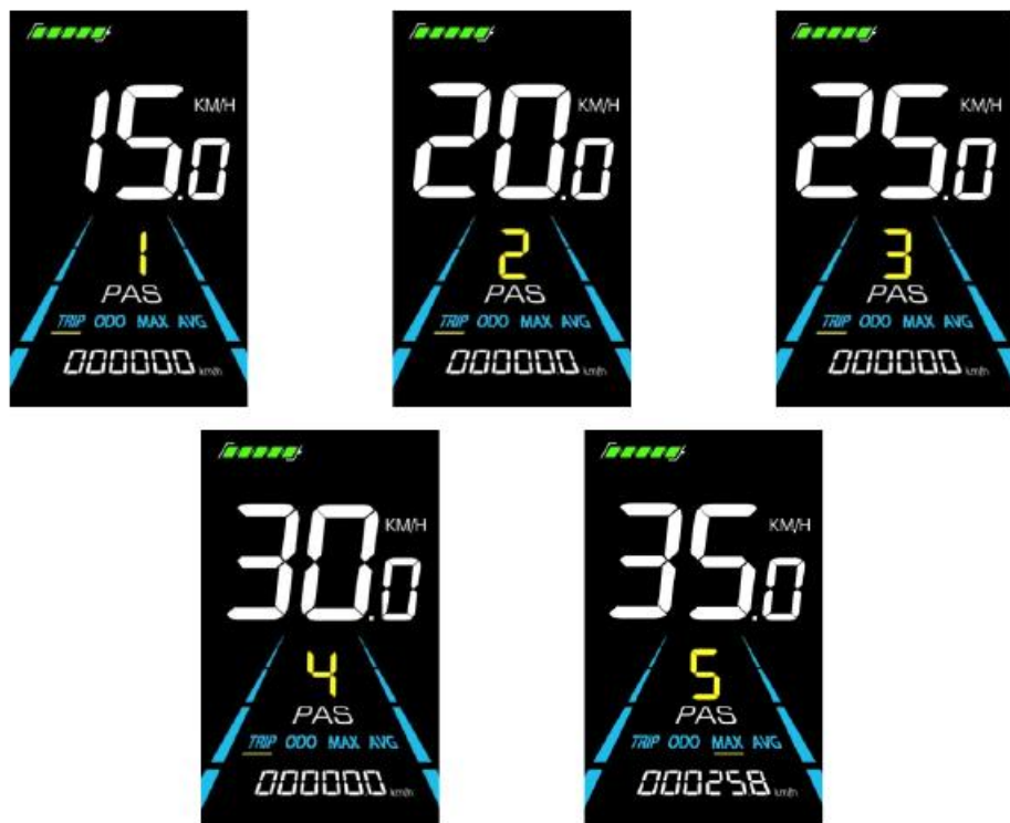
Figure 2-4 PAS level display interface
